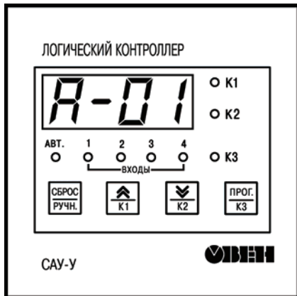
Рисунок 3.1 – Внешний вид лицевой панели прибора для корпуса настенного (Н) крепления
