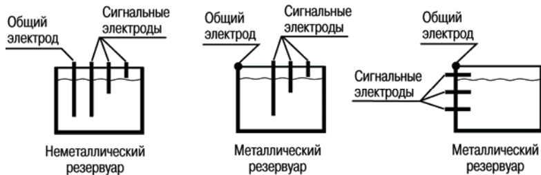
Рисунок 3.5 – Примеры установки кондуктометрических зондов
