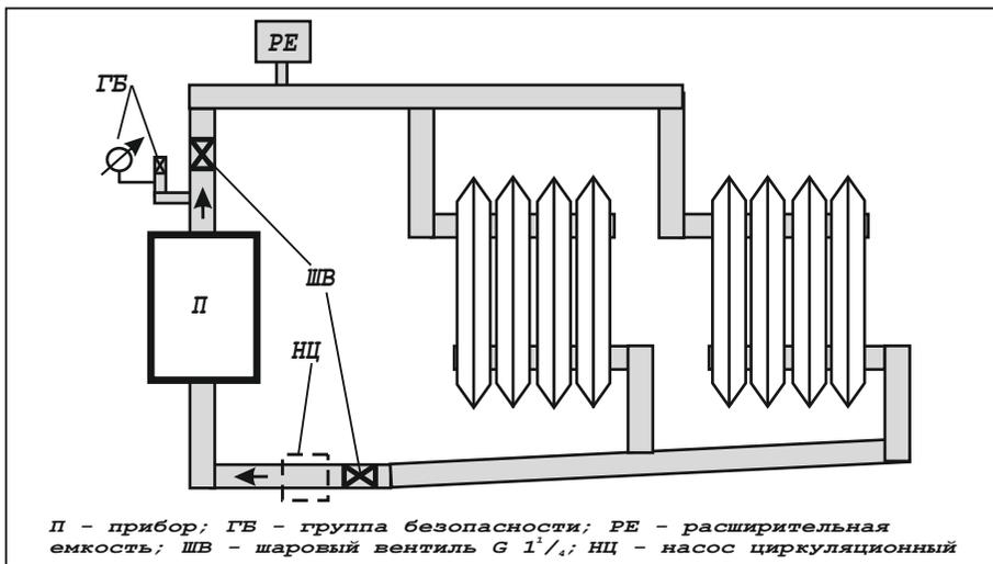
**Рисунок 2 - Примерная схема системы отопления** расширительной емкости мембранного типа (экспанзомата) на выходе из прибора перед шаровым вентилем должна устанавливаться группа безопасности, включающая в себя предохранительный клапан, рассчитанный на давление не более 0,6 МПа, манометр и автоматический воздухоотводчик.
