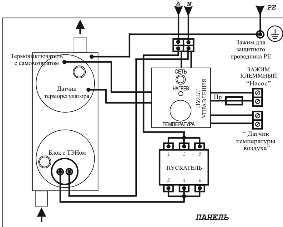
**Рисунок 3. Электрическая схема подключения**
