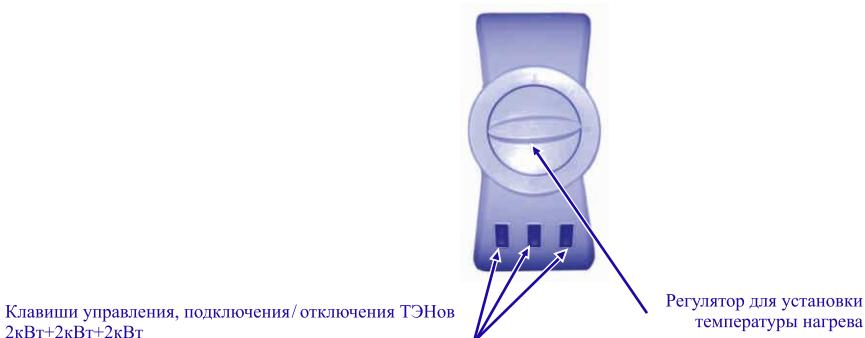
Рис.2. Расположение функциональных кнопок блока управления.
